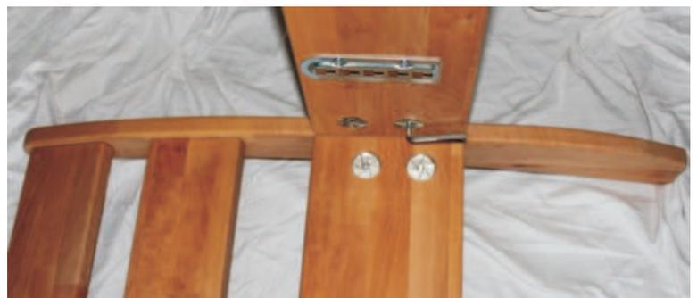
5. Die Lattenrosthälter mit den 20mm langen Schrauben in die vorgekörnten Löcher schrauben. Rundung nach oben.
