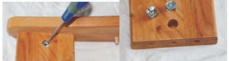
4. Drehen Sie die Exzenter abwechselnd fest zu. (Uhrzeigersinn). Die Bettzargen werden nun fest an das Bein herangezogen. Inbusschlüssel liegt bei.
